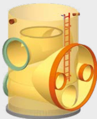
Desbordamiento de aguas pluviales, entrada del canal
