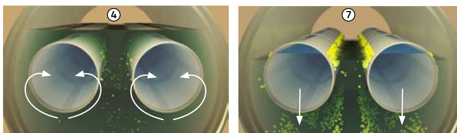
Almacenamiento en PRFV con sistema de retención de sólidos Amiscreen de Amiblu
