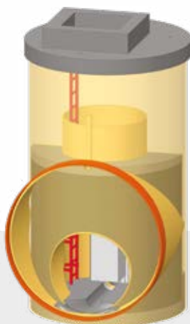
Control de caudal Vortex, funcionamiento en húmedo
