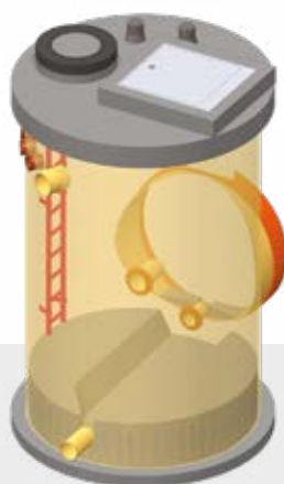
Regulación mecánica del caudal, funcionamiento semiseco
