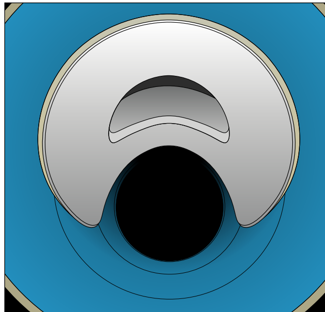
Fig. 60: Réparation d'un branchement latéral avec "Top Hat".
